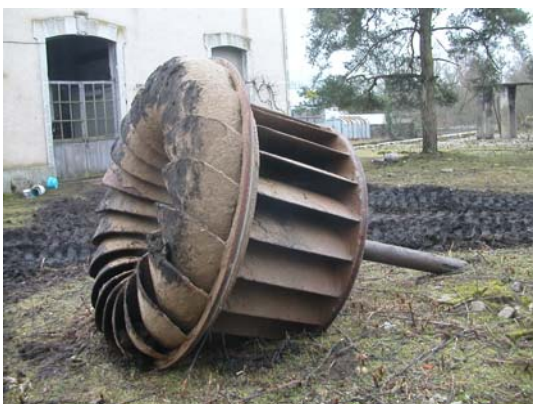
Turbine Groupe 1 lors de son reconditionnement
